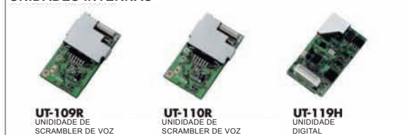
UT-109R: Mais de 32 códigos de controle são disponíveis. UT-110R: Mais de 1020 códigos de controle são disponíveis. UT-119H: Unidade digital. Capacidade digital de 6.25kHz.
