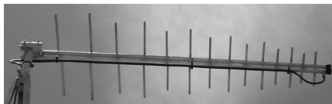
A fixação do Cabo ao longo da antena
